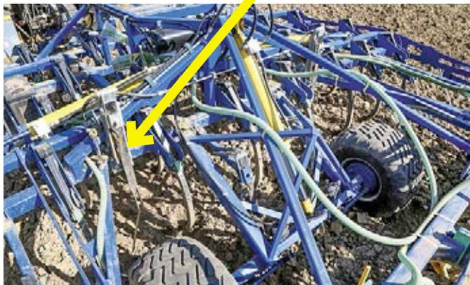
*Gut gelöst: Sobald die Achse hochgezogen wird, werden die beiden Harbox-Zustreicher vor den Rädern hydraulisch unter die Pneu's geschwenkt.*
