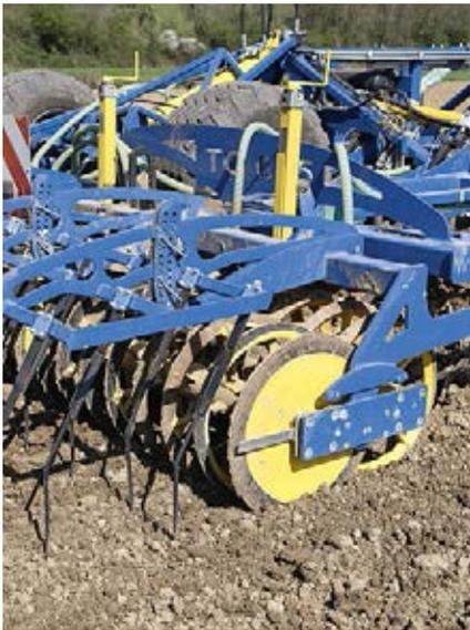
Am Heck sorgt eine Kombination aus einer pendelnden Dachring- und Ringstahlwalze für die Tiefenführung und Rückverfestigung.
