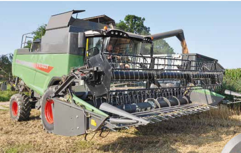
Das PowerFlow-Schneidwerk mit Bändern hat Vorteile, Verschleiß und Wartung sind aber höher. Prima ist die Überladehöhe beim Abbunkern.
